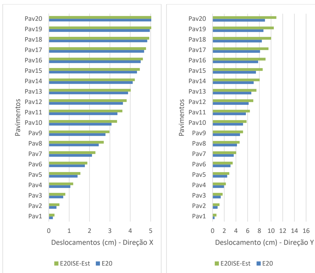
Figura 13 – Comparação deslocamentos laterais - Estrutura de 20 pavimentos
